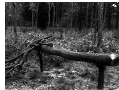
Een geïmproviseerde klopbank om de schors los te kloppen voor de looizuurwinning. Foto: www.historiegaasterland.nl
